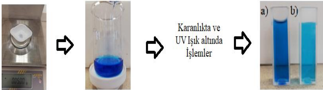
Şekil 30. Sentetik boya indirgenme reaksiyon deneyi şematik gösterimi ( a) karanlıkta bekletilen numune, b) UV ışık altında bekletilen numune).
