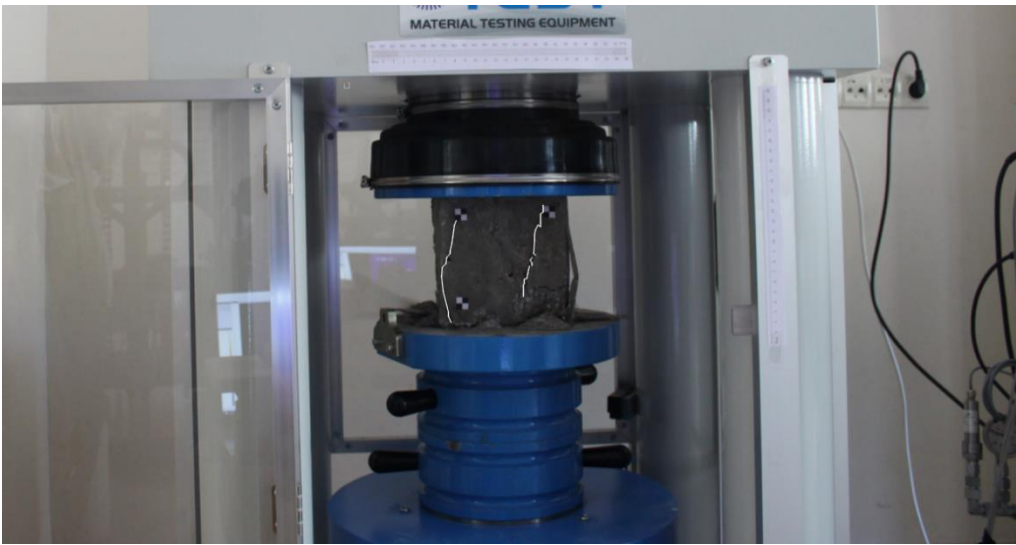
Şekil 25. 1 Numaralı numune üzerinde çizilen çizgisel çatlaklar
