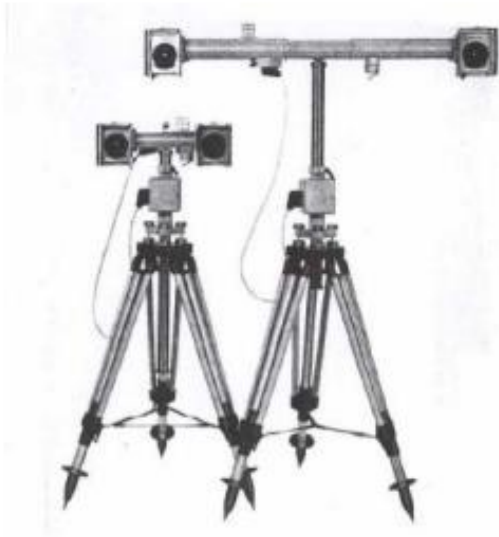
Şekil 2. Çift resim çekme makinesi (Zeiss SMK 40/120)
