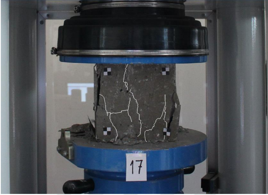
Şekil 73. 17 Numaralı numune üzerinde çizilen çizgisel çatlaklar
