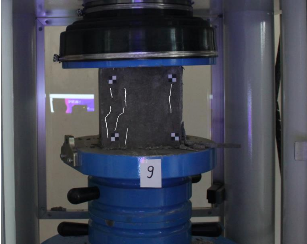
Şekil 49. 9 Numaralı numune üzerinde çizilen çizgisel çatlaklar
