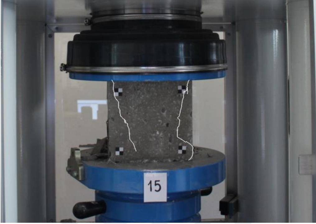
Şekil 67. 15 Numaralı numune üzerinde çizilen çizgisel çatlaklar
