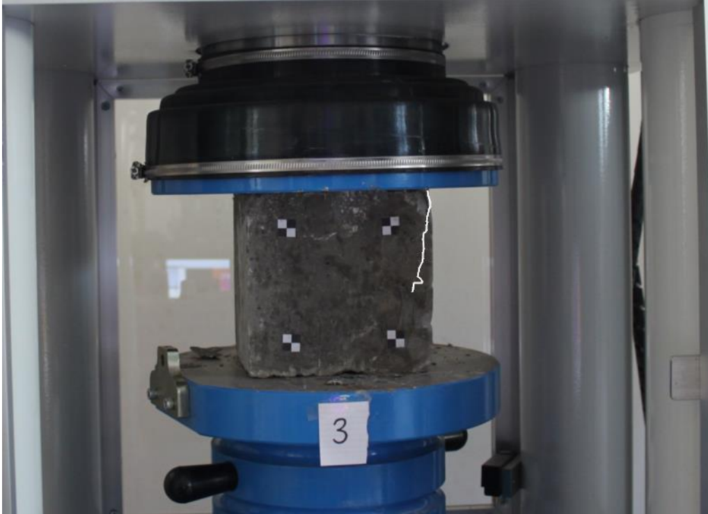
Şekil 31. 3 Numaralı numune üzerinde çizilen çizgisel çatlaklar
