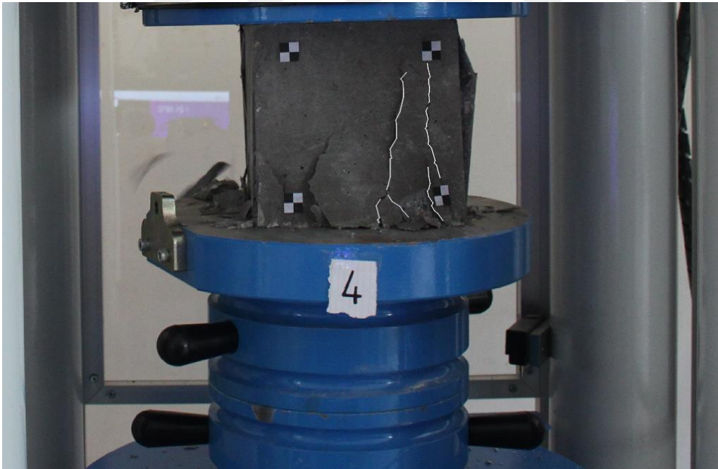
Şekil 34. 4 Numaralı numune üzerinde çizilen çizgisel çatlaklar
