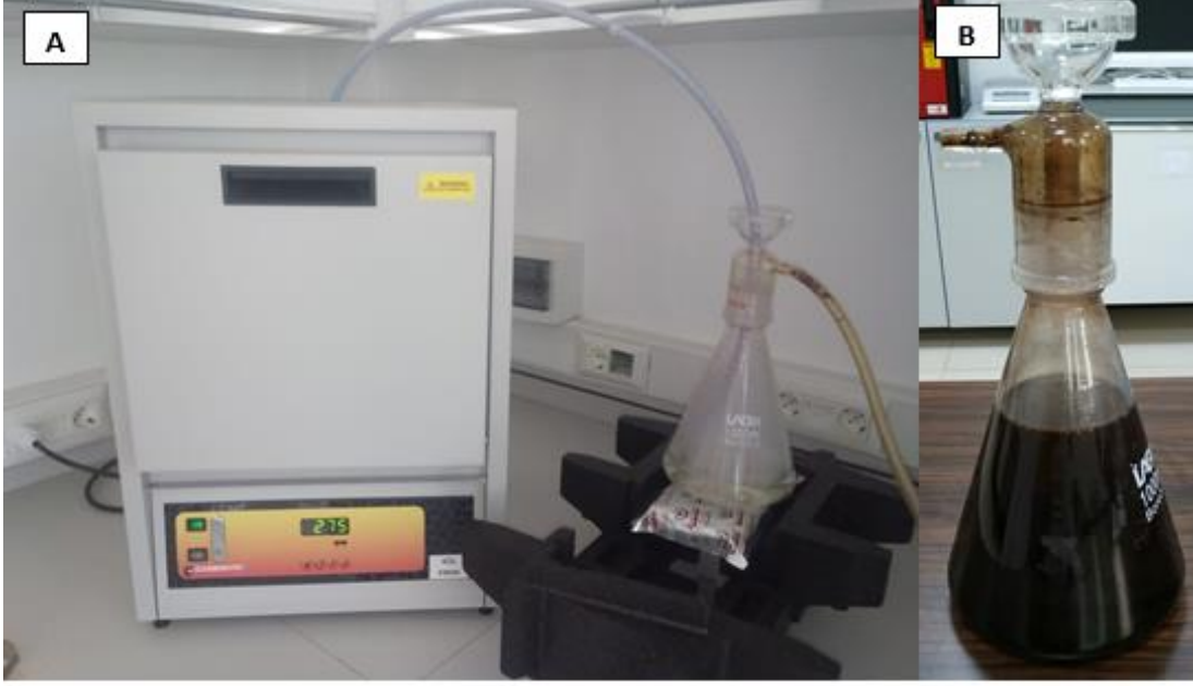
Şekil 3. A: Yonca samanını kül fırınında yakma işlemi, B: Elde edilen duman suyu.
